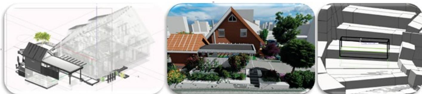
**Abb. 2:** Georeferenzierter digitaler Zwilling einer Doppelhaushälfte [Umsetzung: EliteCAD und Lumion]
