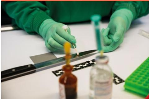
In der DNA-Analytik (FG 51.1) erfolgt die Sicherung von DNA-Spuren. Dabei werden an dem Messer nicht nur die blutverdächtigen Antragsungen, sondern auch die Hautepithelzellen vom Griffbereich gesichert, untersucht und analysiert.
