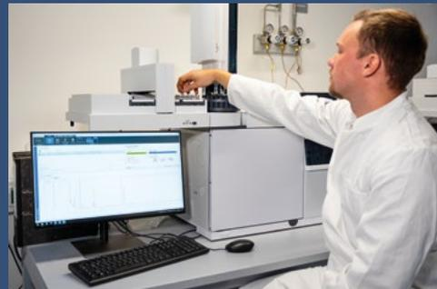
Mittels GC-FID-Analyse (Gaschromatograph mit Flammenionisationsdetektor) wird der Wirkstoffgehalt des zuvor mittels GC-MS-Analyse (Gaschromatograph mit Massenspektrometer) identifizierten Cocains bestimmt.
