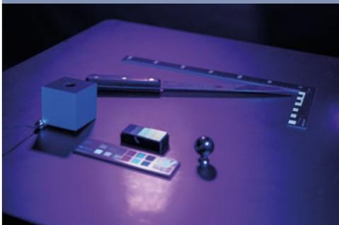
Mitarbeitende der forensischen Medientechnik (Dezernat 55) nutzen die Multispektralfotografie, um hochauflösende Übersichtsaufnahmen der gefundenen Spuren anzufertigen und mögliche weitere Spuren am Messer sichtbar zu machen.
