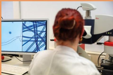
Die gesicherten Fasern werden zur Vergleichsuntersuchung mikroskopisch begutachtet und befundet.
