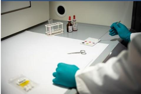
Bei der ersten Sichtung des Asservates unter einem Abzug im Bereich Toxikologie der FG 53.2 zeigt die Blaufärbung des Cobalt(II)-thiocyanat-Vortestes, dass voraussichtlich Cocain vorliegt.
