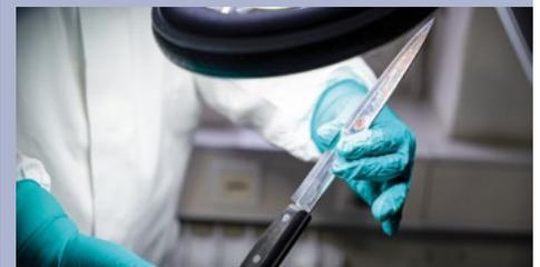
Das Messer wird im Zentrallabor Daktyloskopie (FG 54.1) vor einer Cyanacrylatbedampfung einer Sichtkontrolle mithilfe von Lichtlupe unterzogen. Unbehandelt sichtbare daktyloskopische Spuren werden schon jetzt fotografisch gesichert.
