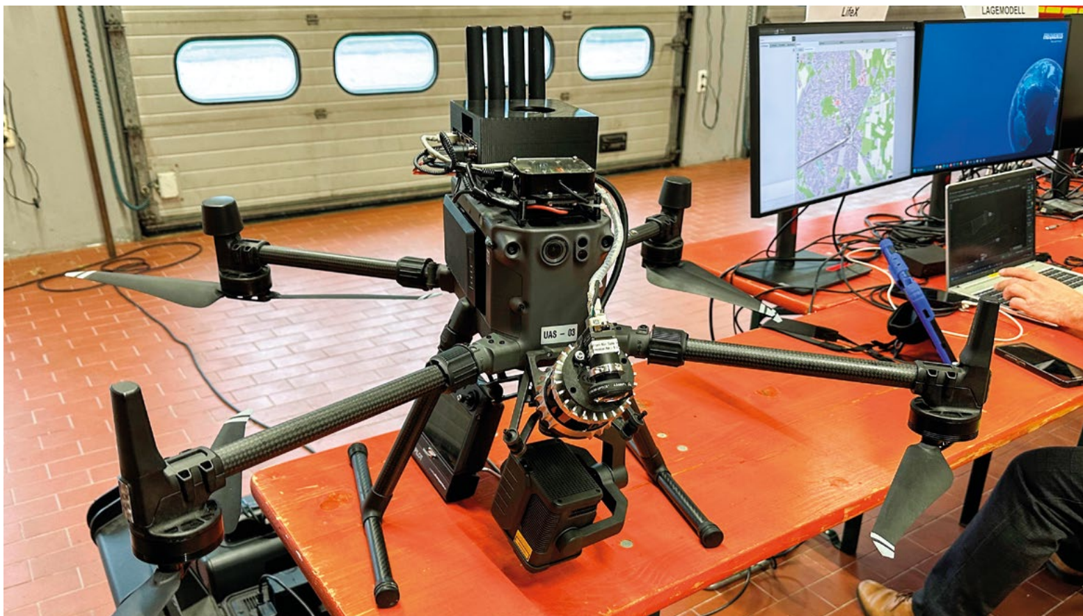
Der eigens für das Projekt entwickelte On-Board-Computer oben auf der Drohne steuert sie.
